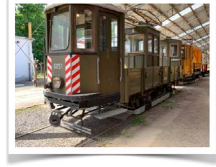
WIEN AT 6051 – SCHLEIFWAGEN ROHRBACHER BAUJAHR: 1914/1923
